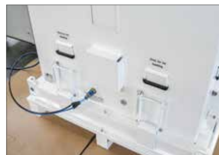
Герметичный контейнер во время проверки избыточным давлением
